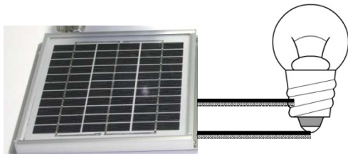
電球と太陽電池を直接接続
