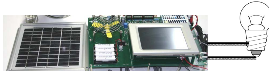
MPPT制御して電球に接続
