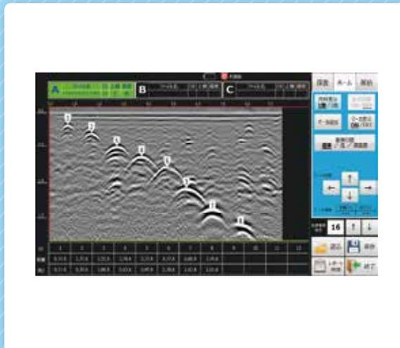
▲埋設管の反射波を自動検出し、
