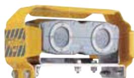
ブラクステールは、現場内で人（歩行者・作業者）とその他の障害物を区別して、警報を出せる最先端の「インテリジェント・カメラ・システム」です。
