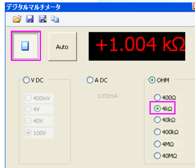
レンジ選択、計測開始し、計測値を確認
