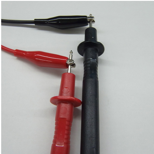
プローブをFGケーブルと接続
